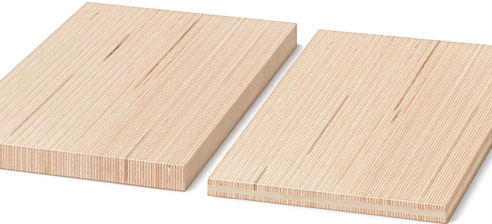
Für großflächige Anwendungen in den Stärken 19/20mm wird die Verwendung der BauBuche Paneel X empfohlen. Die Paneel X ist durch den Plattenaufbau als Dreischichtplatte besonders verzugsstabil und weist ein deutlich reduziertes Quell- und Schwindverhalten auf. Darüber hinaus ist die Paneel X in einer größeren Plattenbreite erhältlich.
