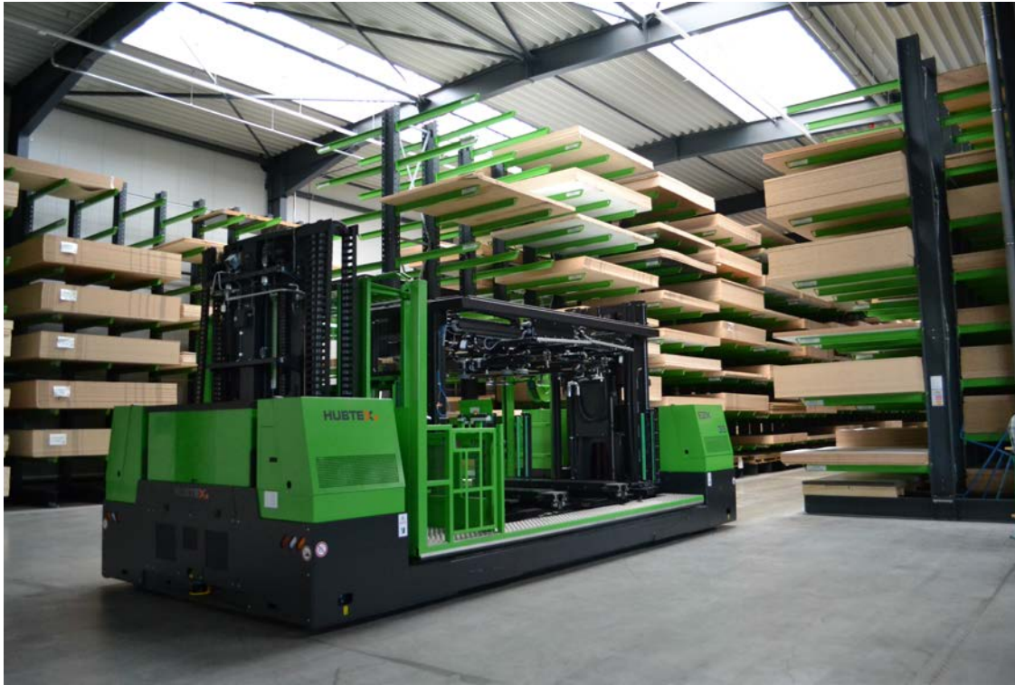
Platten-Kommissionier-Anlage Bildrechte: BECHER GmbH & Co. KG
