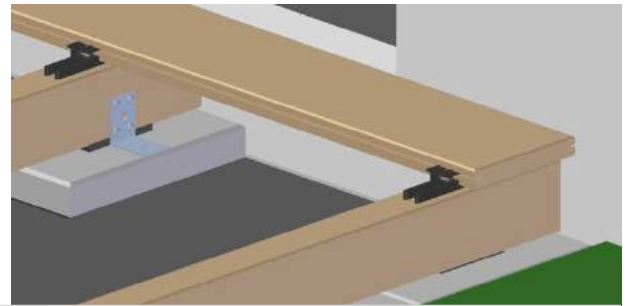
Bild 8. Je Unterkonstruktion 1 H-Stick verwenden.
