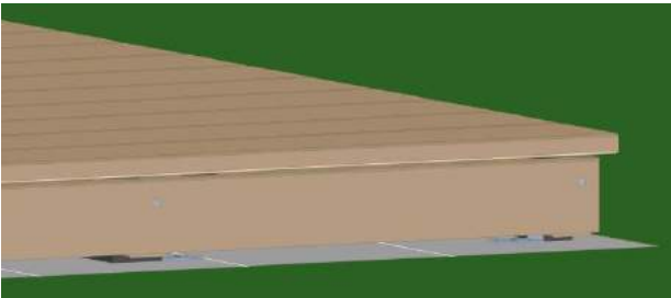
Bild 20. Das Blendbrett sollte mit Luft zum Boden und zur Diele montiert werden.
