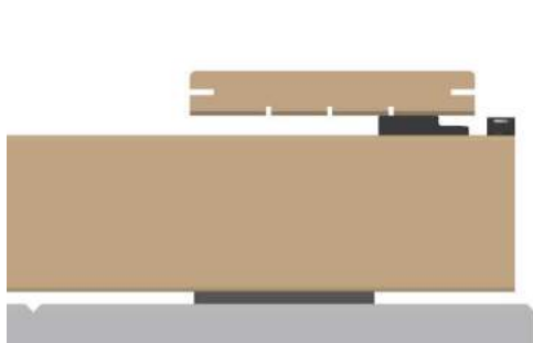
Bild 5. Diele umdrehen und vorsichtig in den Halter einschieben
