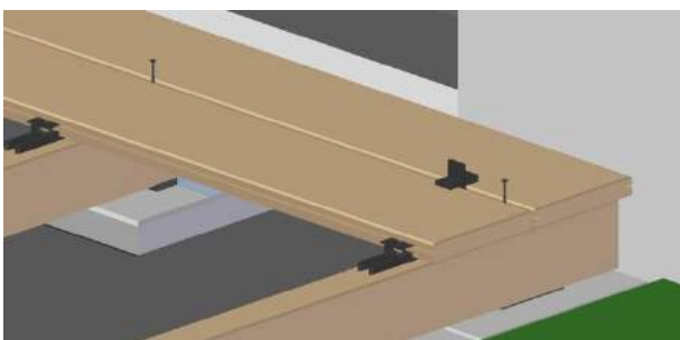
Bild 11. Beiliegende Schrauben einsetzen und festschrauben
