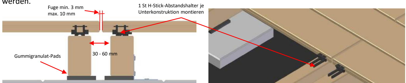
Bild 21. Längsstöße von Terrassendielen müssen immer zwei Unterkonstruktionen ausgeführt werden.
