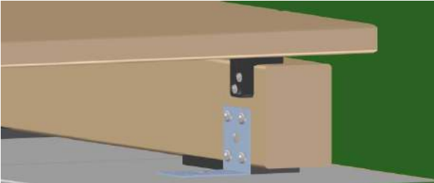
Bild 18. Montage Endclip an der Unterkonstruktion aufliegen.
