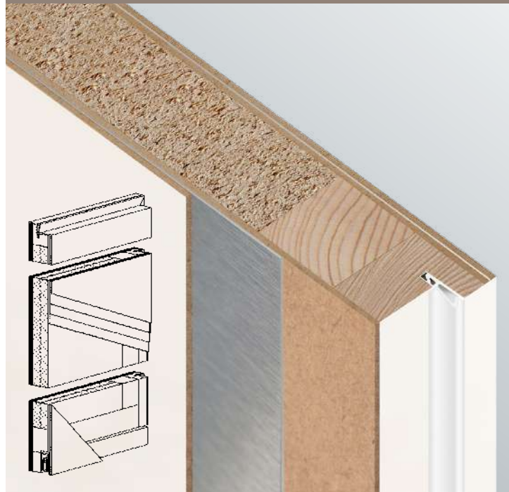
Türblattaufbau mit Aluminiumverbundabsperung
