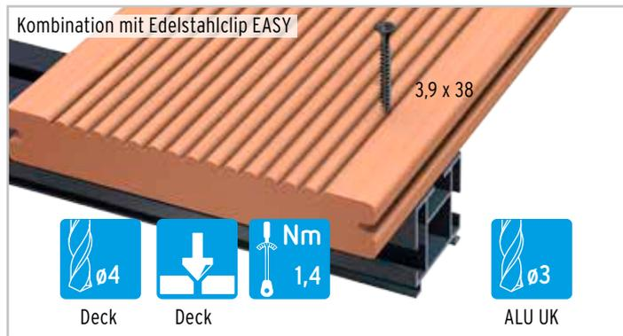
Montieren Sie die DREAMDECK WPC mit dem Edelstahlclip EASY, wird die erste und die letzte Diele direkt mit der UK verschraubt.
