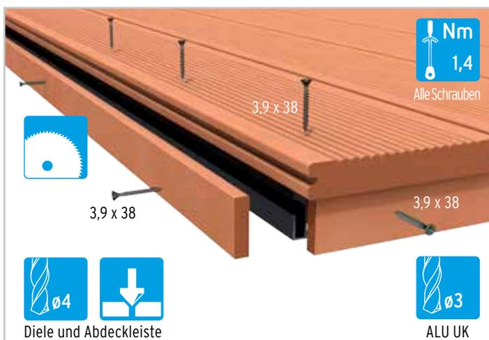
Nach Montage der Dielen, die Abdeckleiste an die Höhe der UK anpassen und gegen die UK schrauben. Die Abdeckleiste darf nach unten nicht über die UK überstehen, da das die notwendige Luftzirkulation einschränkt.
