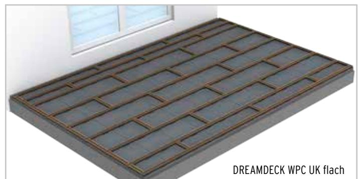
Verwindungssteife Unterkonstruktionsrahmen mit geringer Einbauhöhe können aus den flachen UK ALU/WPC und zusätzlichen Winkeln aus Edelstahl montiert werden. Eine mögliche Lösung falls eine Befestigung der Unterkonstruktion mit dem Untergrund nicht machbar ist.
