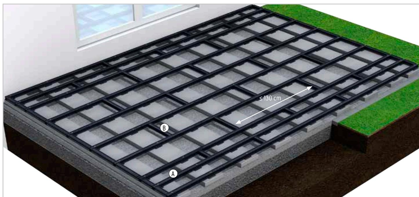
An **Stellen mit höherer Belastung**, z. B. an Türen, an Antrittsstellen, bei Übergängen zu Treppen, bei der Platzierung von schweren Blumenkübeln oder Sonnenschirmen, **müssen Sie eine zusätzliche UK (A) 36 cm montieren**. Achten Sie darauf, dass an diesen Stellen keine Staunässe entstehen kann. Durch die zusätzliche Belastung oder das Gewicht darf die typische Materialausdehnung nicht verhindert werden. Hier kann es sonst zu Verformung der DREAMDECK Elemente kommen.
