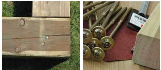
Massiv: Aus Holzschwellen – dieser rustikale „Buddelkasten“ hält auch stärksten Beanspruchungen durch die Kids stand.
